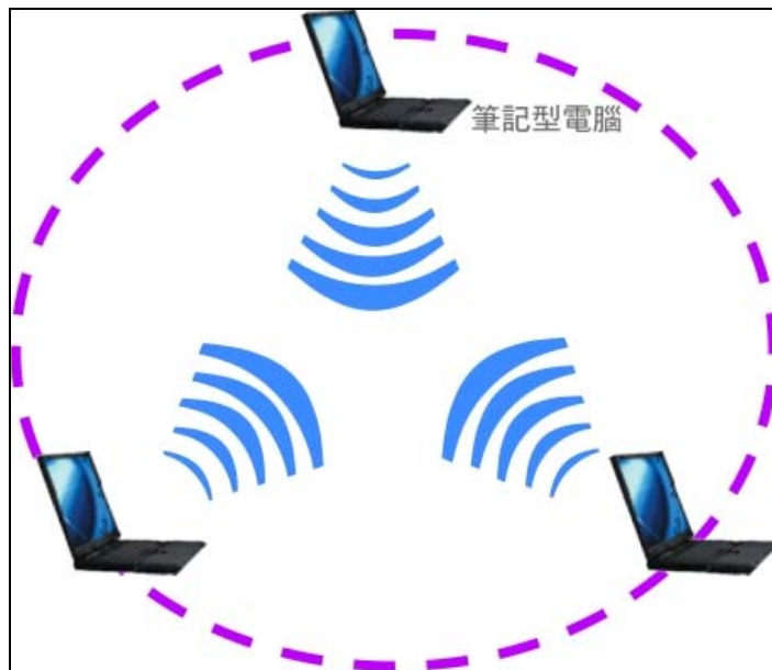
圖 4 、802.11b 簡易模式(Ad-Hoc Mode)網路拓譜
