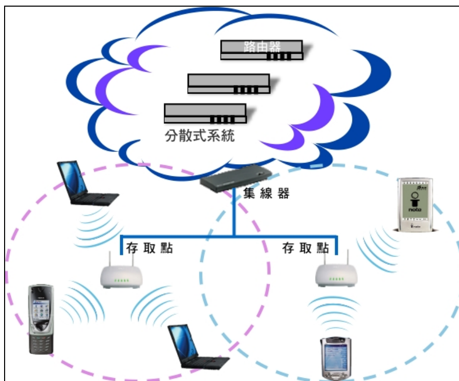
圖 3、802.11b 基礎建設模式(Infrastructure Mode)網路拓譜
